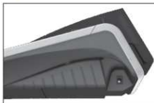
Pripojenie adaptéra alebo iného externého zdroja
