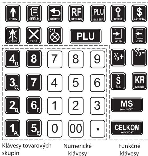
Obrázok 2.4 – Základná klávesnica pokladnice Euro-2000T/TE Alpha a jej delenie
