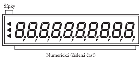
Obrázok 2.5 Rozdelenie segmentového LCD displeja
